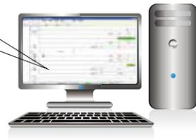
可直接于 PC 上监控梯形图执行状态，且可实时变更暂存器状态，大幅减少程序验证、除错时间
